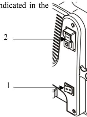
FIG. n°8 - Controls position
